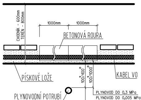
KŘÍŽENÍ KABELU VO A PLYNOVODU
